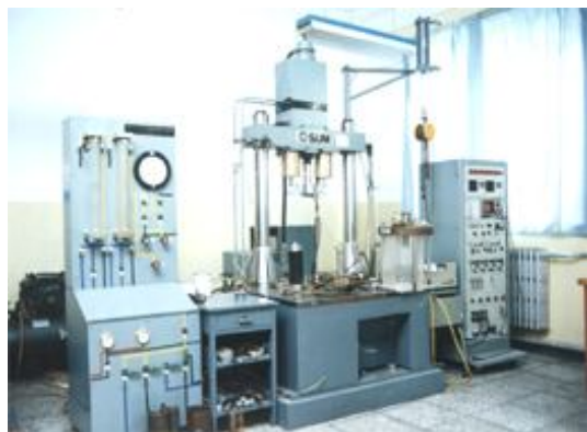
图 1 S3D 中型动三轴仪
